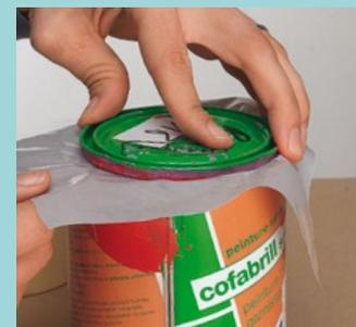
Nettoyez soigneusement les bords du pot avec soin, et interposez un film plastique entre le couvercle et le pot.
