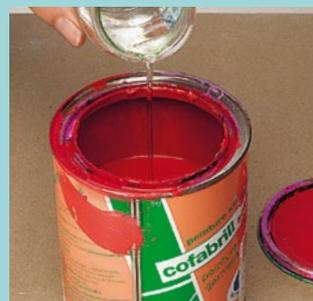
Déposez une couche d'eau d'un centimètre sur le dessus de la peinture avant de le refermer.
