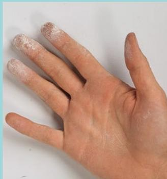
S'il s'agit d'une peinture à l'eau, le diagnostic est simple : frottez le plat de la main sur la peinture. Si les doigts se couvrent de poussière, la peinture a « fariné ». Il faut la décaper.
