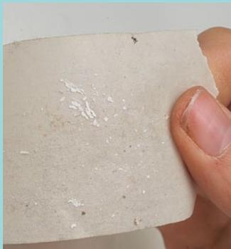
S'il s'agit de peinture à l'huile, collez par endroits des morceaux de ruban adhésif. Si, en les arrachant, des morceaux de peinture restent collés, il faut décaper avant toute autre opération.
